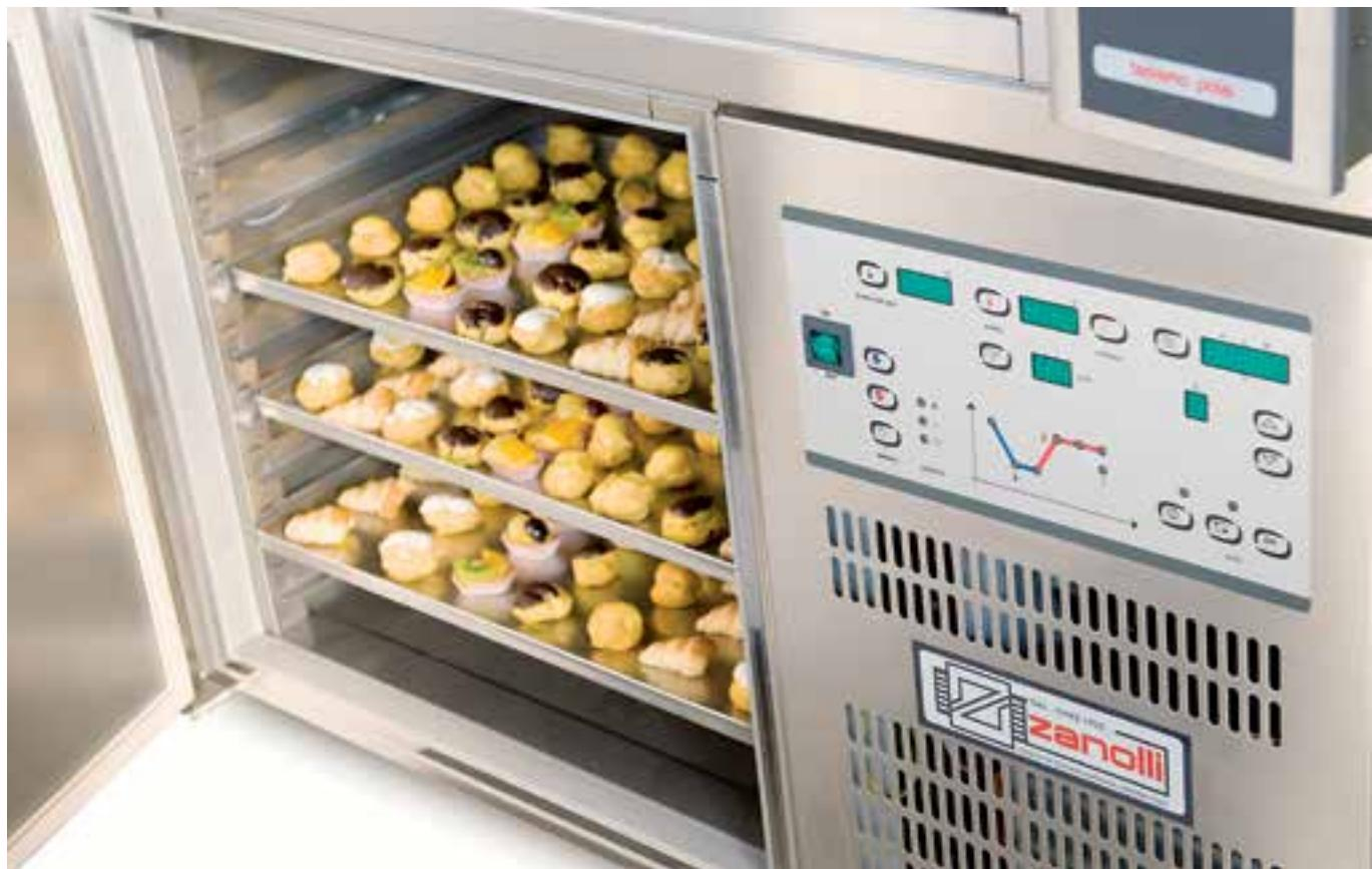
Con la cella di fermalievitazione Garda è possibile programmare e controllare il ciclo di lievitazione, alternando fase "fredda" di conservazione del prodotto e fase "calda" di lievitazione.
